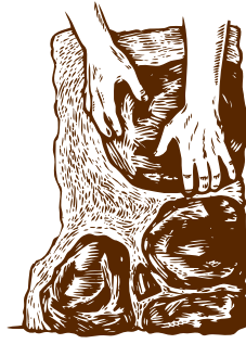
FIG. 6 แล้วจึงติดตั้งหินชนิดแผ่น ให้เว้นรอยต่อ ประมาณ 1.5 ซม. (ในการนี้ต้องยกแหวน)
