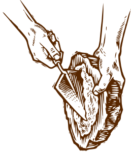
FIG. 4 ปาดปูนกาวบนผนังบริเวณที่จะติดตั้ง และ ปาดปูนบนหลังหินให้ทั่ว ระวังอย่าให้ปูน เลอะโดนหน้าหิน
